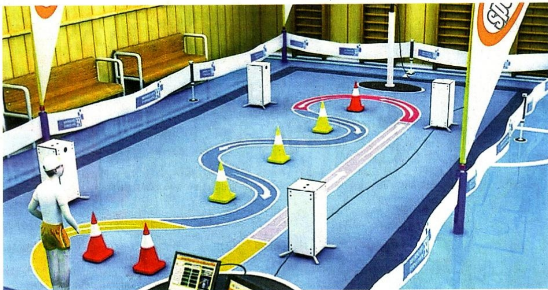
Diesen Laufparcours müssen die Kinder in möglichst kurzer Zeit zurücklegen. Lichtschranken messen ihre Geschwindigkeit, ihre Reaktion und die Beweglichkeit. Foto: AOK
